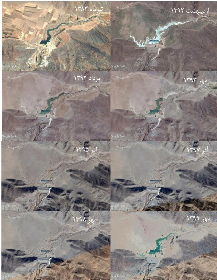
تصویر ۳- وضعیت آبیگری سد سیوند از آغاز ساخت تا سال ۱۳۹۹ (Google Earth).
